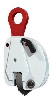
Захват прост в конструкции и в эксплуатации. Обеспечивает безопасный подъем и перемещение листового проката, уголков, швеллеров, двутавровых балок. Работа захвата основана на зажиме листового материала эксцентриком за счет силы трения.
