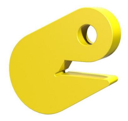
Торцевой захват для труб используется при погрузке-выгрузке труб кранами на транспортные средства, для поднятия и перемещения труб в горизонтальном положении. Захват для труб позволяет предотвратить повреждение изоляционного покрытия при погрузочно-разгрузочных работах. Выемка в захвате не дает трубе соскользнуть и опрокинуться.
